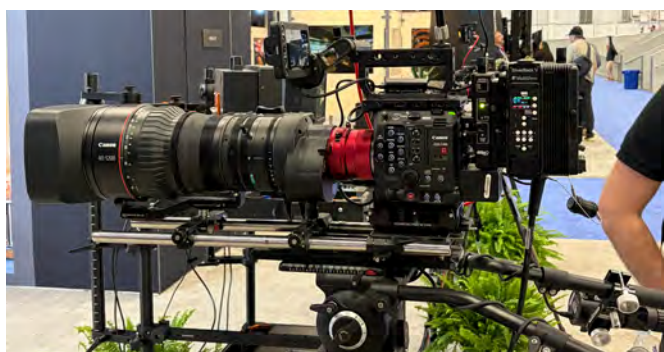
Sensor nativo Super 35mm com extensor integrado de 1,5x para cobertura full-frame.
