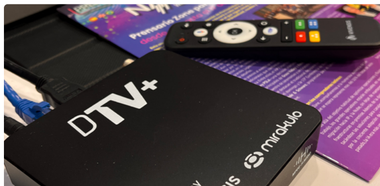
Primeiro set-top-box para receber DTV+ (TV 3.0) desenvolvido pelo Fórum SBTVD, Vivensis e Mirakulo. Foto de Fernando Moura no estande da Mirakulo no pavilhão do ATSC
