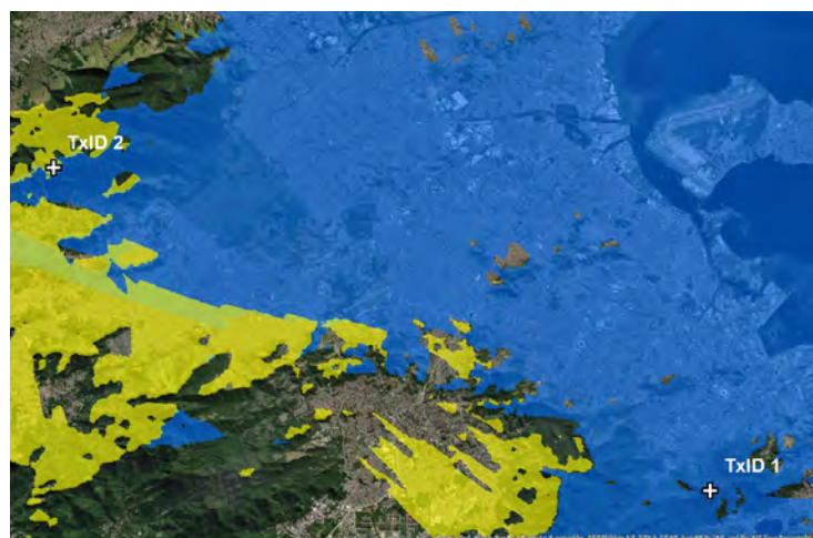
Figura 7 - Exemplo de cobertura de TxID, com identificação apenas do sinal mais forte
